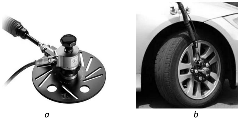
Hình 3 (a) Cảm biến WPT; (b) Vị trí lắp đặt cảm biến WPT trên xe
