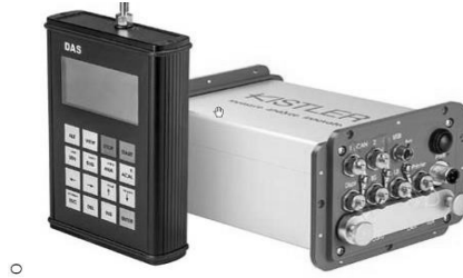
Hình 1. CDS Logger và bộ điều khiển Kistler
